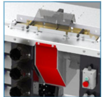
Ambos modelos del "Hose Room on Wheels" vienen equipados con una versión integrada de la cortadora S CUT 30 L y su disco dentado para un corte eficiente y preciso y con una producción muy baja de humo.
