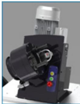
Con 137 toneladas de fuerza de prensado, un tamaño increíblemente compacto y su cabezal giratorio de prensado, la prensa S CRIMP 137 EVO R es el elemento estrella de esta versión del Hose room on Wheels.
