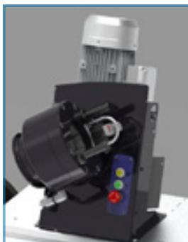
Avec 137 tonnes de force de sertissage, un design compact et une tête orientable pour une position ergonomique, la S CRIMP 137 EVO R est l'élément clé de cette version du "Hose Room on Wheels". Ce modèle convient aux tuyaux WB et WS jusqu'à 1-1/4", et est compatible avec une large sélection de jeux de mors\* ainsi qu'un outil de changement rapide de mors\* (\*en option).
