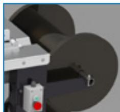
Conçu pour permettre le chargement et le déchargement rapide jusqu'à 4 tuyaux différents, les supports de stockage facilitent également la manipulation et la gestion des bobines pendant l'opération.
