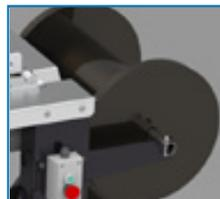
4 bobine di stoccaggio per facilitare la manipolazione dei tubi.
