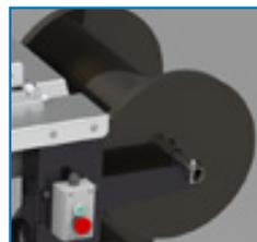
Diseñado para la carga y descarga de hasta 4 mangueras diferentes, el almacenamiento de los carretes de manguera también facilita la manipulación y el manejo durante la operación de prensado y cortado.
